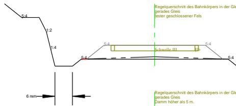
Regelquerschnitt des Bahnkörpers in der Gleisbettung
