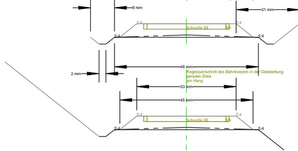
Regelquerschnitt des Bahnkörpers in der Gleisbettung
